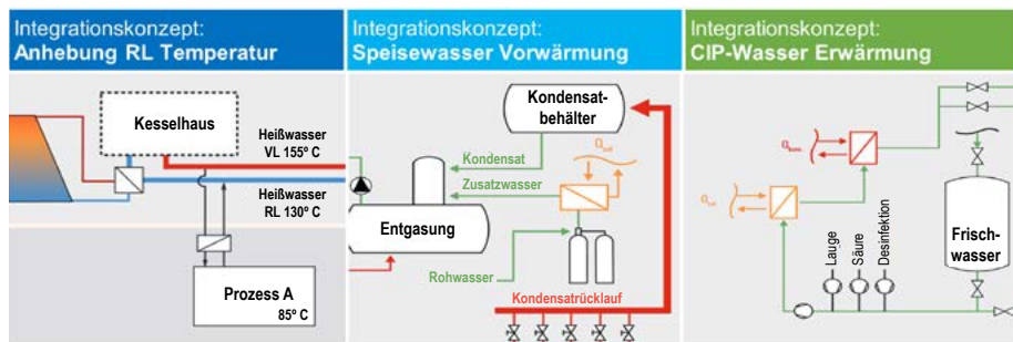
Abbildung 16: Integrationskonzepte für Solarthermie in der Ernährungsindustrie; Bilder aus [7]
