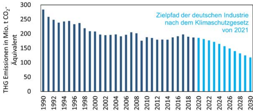
Abbildung 1: Entwicklung der jährlichen THG-Emissionen der deutschen Industrie seit 1990 bis 2019 nach Daten des BMWi [2] und der anschließende Zielpfad nach dem Klimaschutzgesetz von 2021 bis 2030
